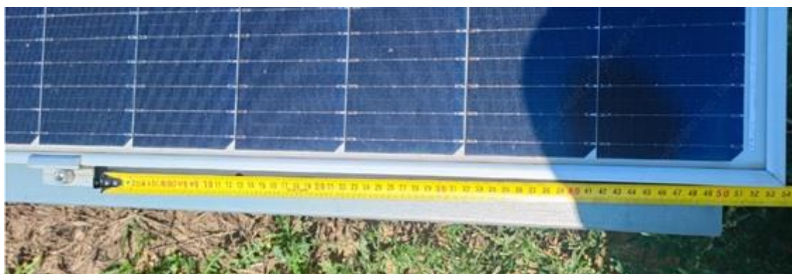
Abb.4 Messen des Abstands der Montageklammer vom Rand des Moduls
