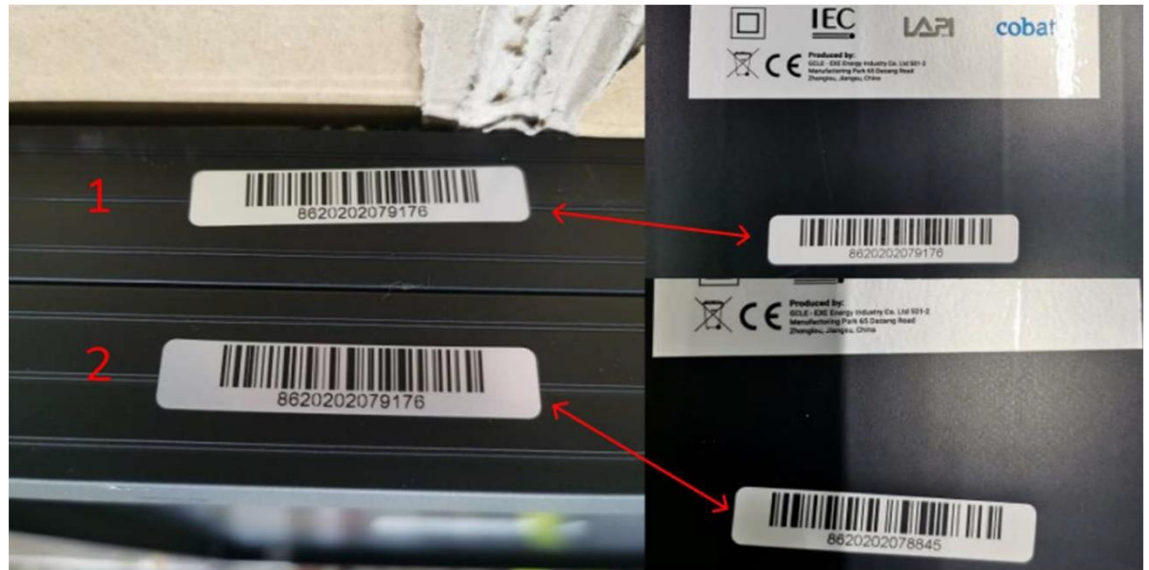
Abb.2 doppelte und falsch aufgeklebte Seriennummer
