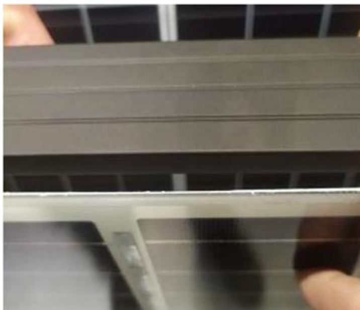
Abb.6 Kein Silikon oder Klebstoff zur Verbindung des Rahmens mit den internen Komponenten
