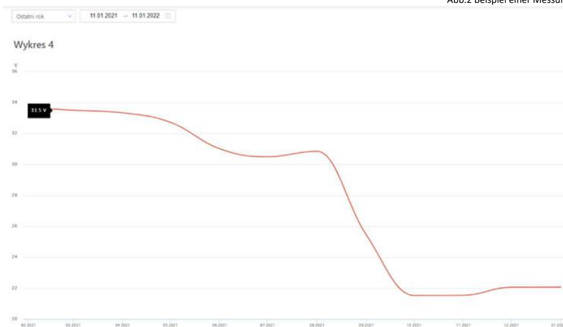
Abb.3 Screenshot aus der Solar Edge Überwachungsanwendung, der den Leistungsverlust zeigt
