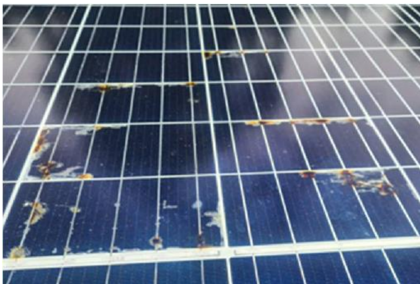
Abb.1 bei der Wärmebildaufnahme sichtbare heiße Stellen
