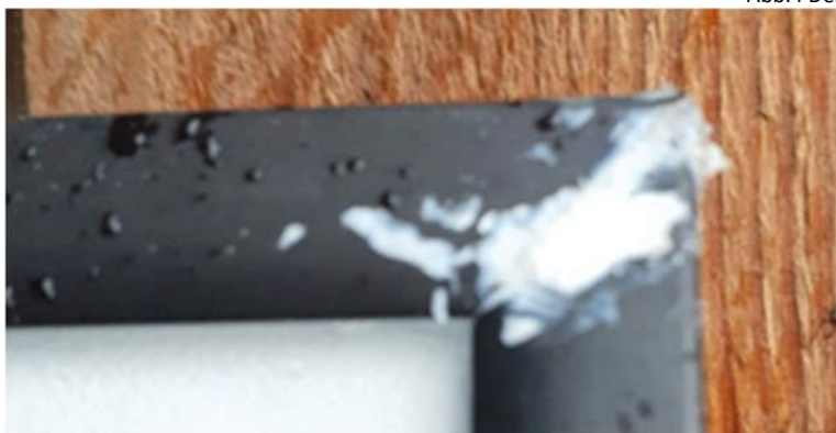
Abb.5 Silikonrückstände aus dem Produktionsprozess
